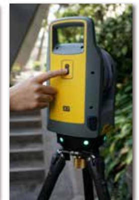
機器横のボタンを押すだけでスキャン開始
