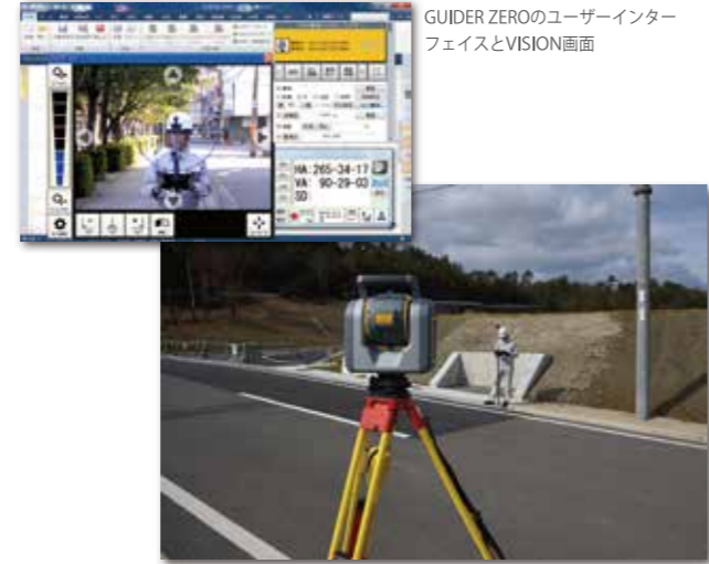
ロボティック機能とGUIDER ZEROを組合わせた効率的な地形測量
