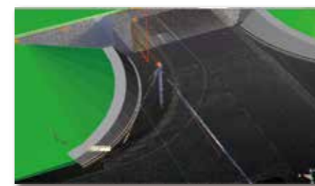
既存構造物と3次元設計データとの3D干渉チェック
