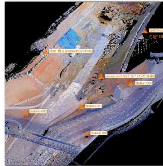
Trimble SX10、Trimble TX8、Trimble S7 SureScanで取得し、合成した複合現場
