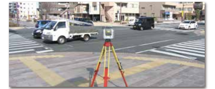
多くの車が行きかう交差点で点群計測
