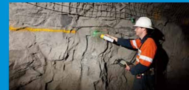
グリーンレーザーで計測ポイントを照射
