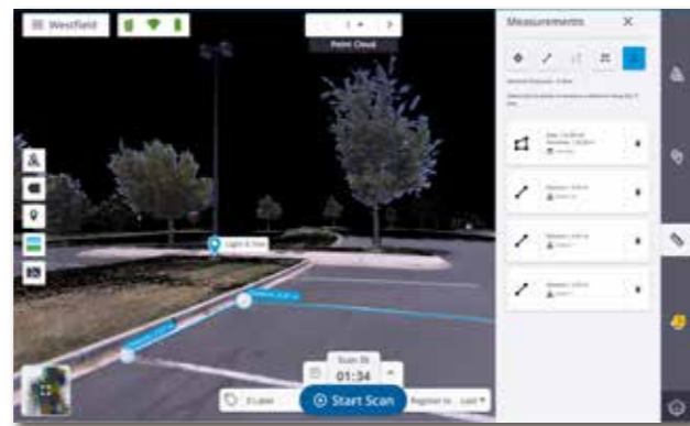
スキャンされた点群を使って、指定した箇所の高さや距離を計測
